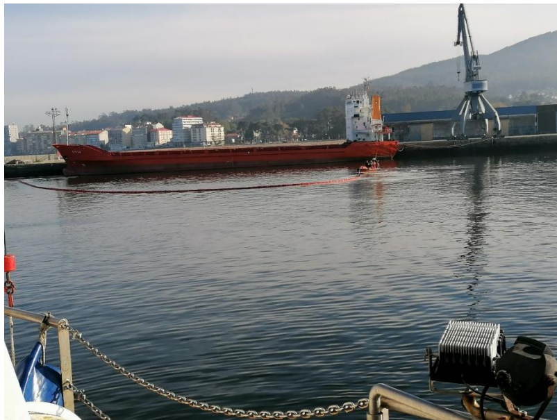
Tendido de barrera en el muelle del Ramal
