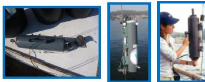
Botella oceanográfica toma muestras tipo Niskin
