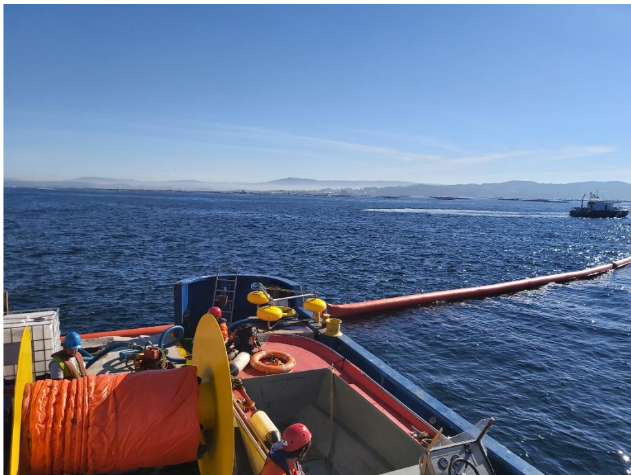
Polígono de bateas de Meloxo, tendido de barrera desde la embarcación DSV Comander, en cubierta Skimmer y Fast-tank
